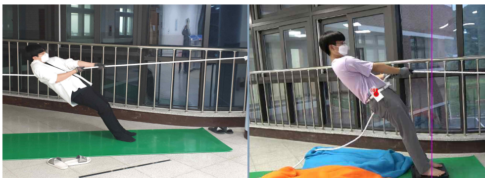
그림 15 각도에 따른 장력 변화 실험을 위한 예비 실험 장면
